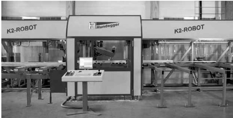
Fig.1. Machining centre Hundegger K-2 [[www.hundegger.de/](http://www.hundegger.de/)]
