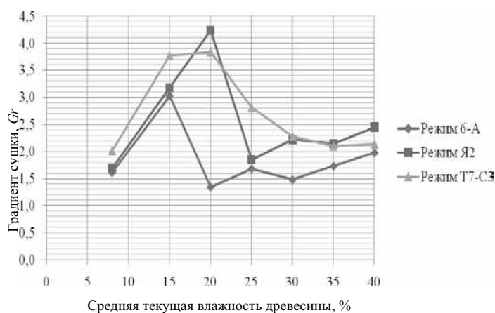
Рис. 2. Графики зависимости Gr от средней текущей влажности древесины ясеня для разных режимов сушки
